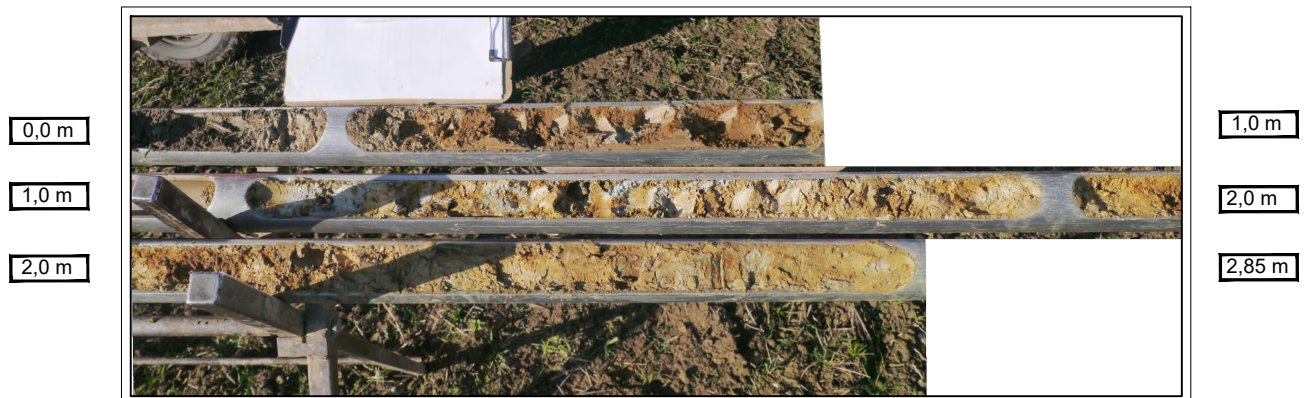
Bild 7: Bohrgut der Sondierbohrung BS 07/20
