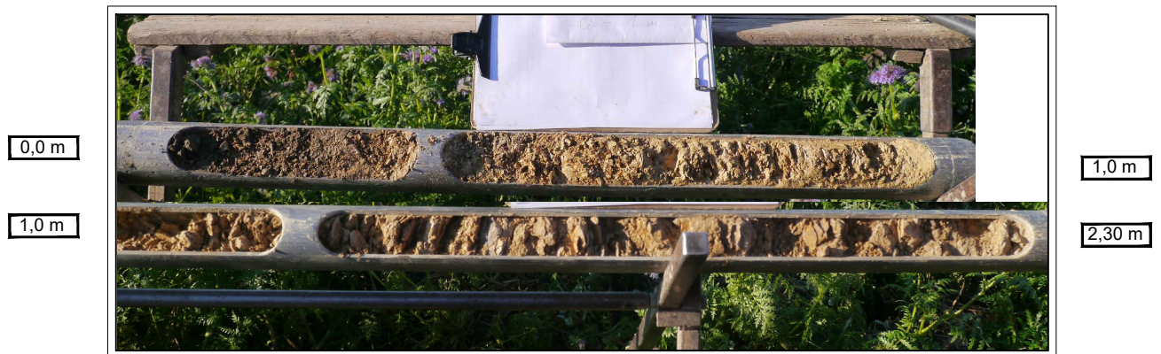
Bild 4: Bohrgut der Sondierbohrung BS 04/20
