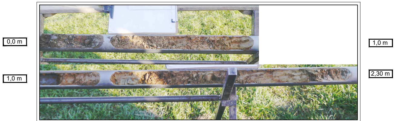
Bild 1: Bohrgut der Sondierbohrung BS 01/20
