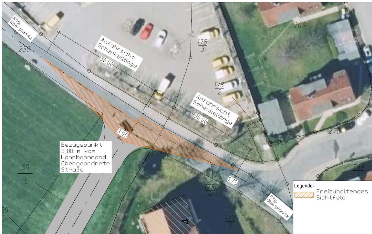
ABB. 1 SICHTDREIECKE FÜR VZUL = 30KM/H (AUSSCHNITT LAGEPLAN)
